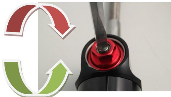
Le réglage de la **compression basse vitesse** s'actionne à l'aide d'un tournevis plat (voir photo ci-contre). Ce réglage possède environ 45 clics.
