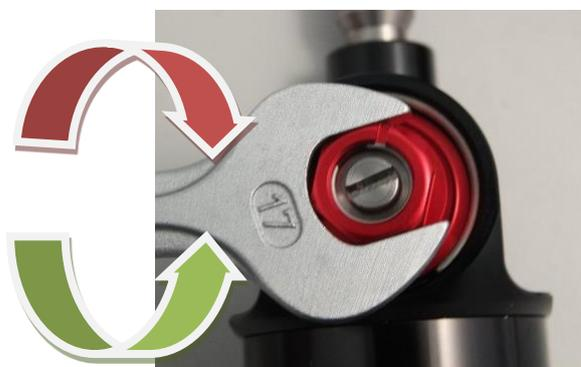
Le réglage de la **compression haute vitesse** s'actionne à l'aide d'une clé de 17. Ce réglage possède environ 5 tours.
